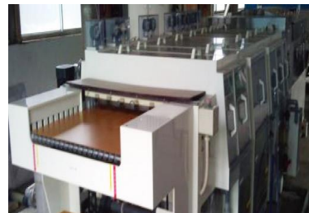
コンベア純水・洗浄装置3号機
